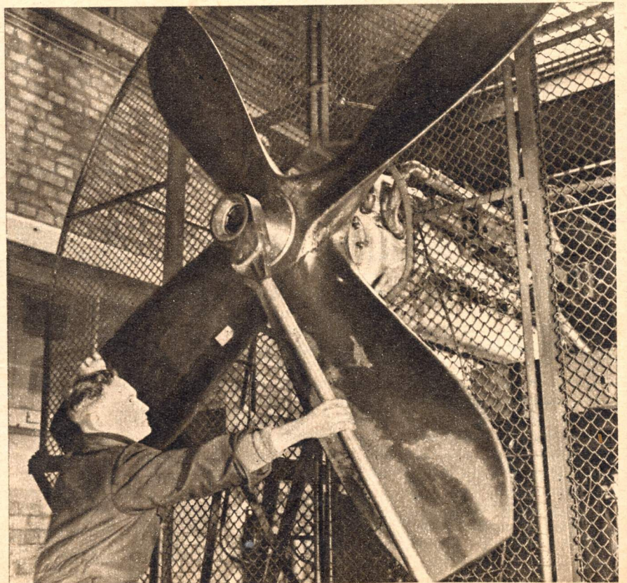
Unten: Auf dem Prüfstand werden die Flugmotoren mit geeichten Bremsluftschraubengefahren. Aus dem Widerstand, den die Blätter in der Luft finden, wird dabei die Leistung des Motors festgestellt
