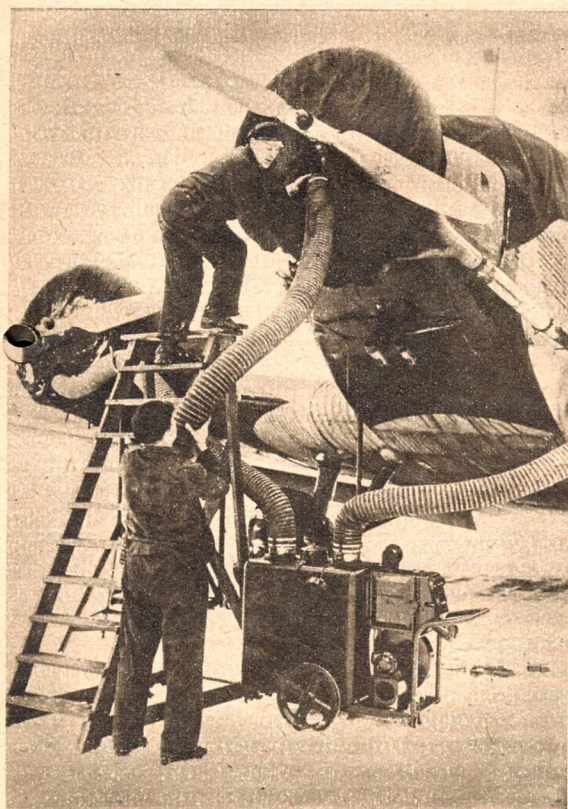
Unten: Im Winter dient erhitze Luft, die durch Schläuche unter die Motorhüllen geblasen wird, zur Vorwärmung der Triebwerke
